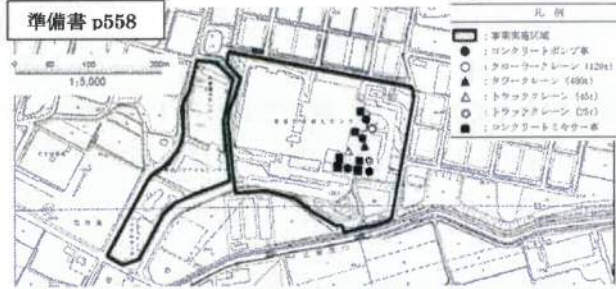
図 8-2-9(1) 建設機械の稼働状況及び稼働位置 (工事開始後 30 ヶ月目 (建設工事))
