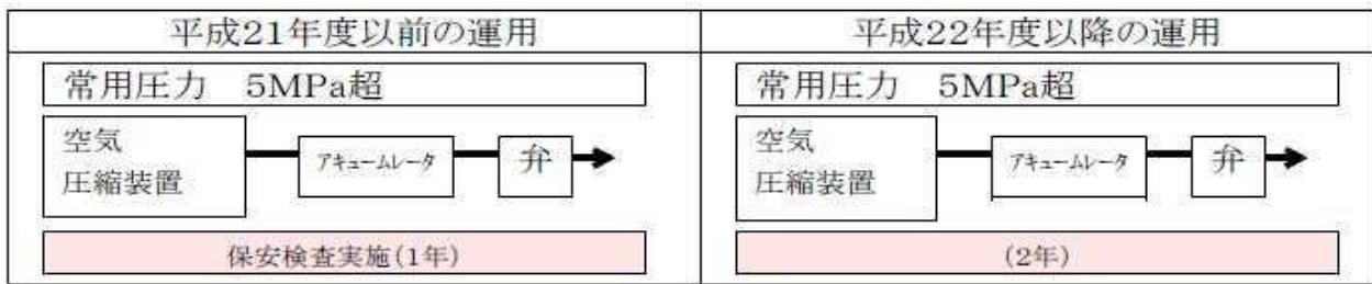
※平成22年度からは、気化器以降の高圧ガス設備が配管及び弁類のみであれば、一体の設備として取り扱うこととします。
