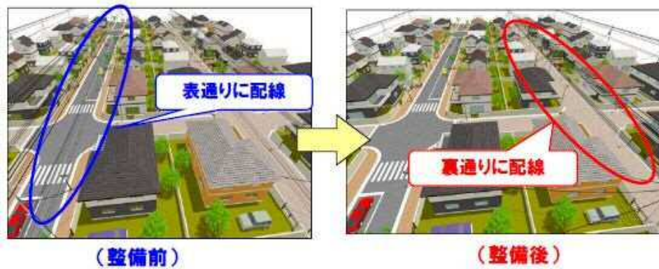
図 2.2-2 裏配線方式イメージ
