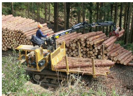
フォワーダによる木材の搬出（岡崎市）
