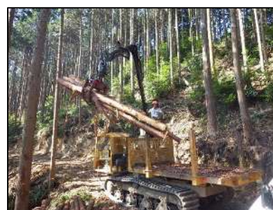
フォワーダによる間伐材の搬出
