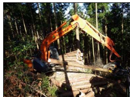
高性能林業機械（プロセッサ）による造材状況（岡崎市）
