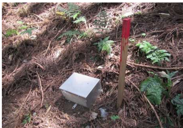
写真-1 土砂受け箱の設置状況
