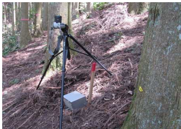
写真-2 天空写真撮影による開空度調査
