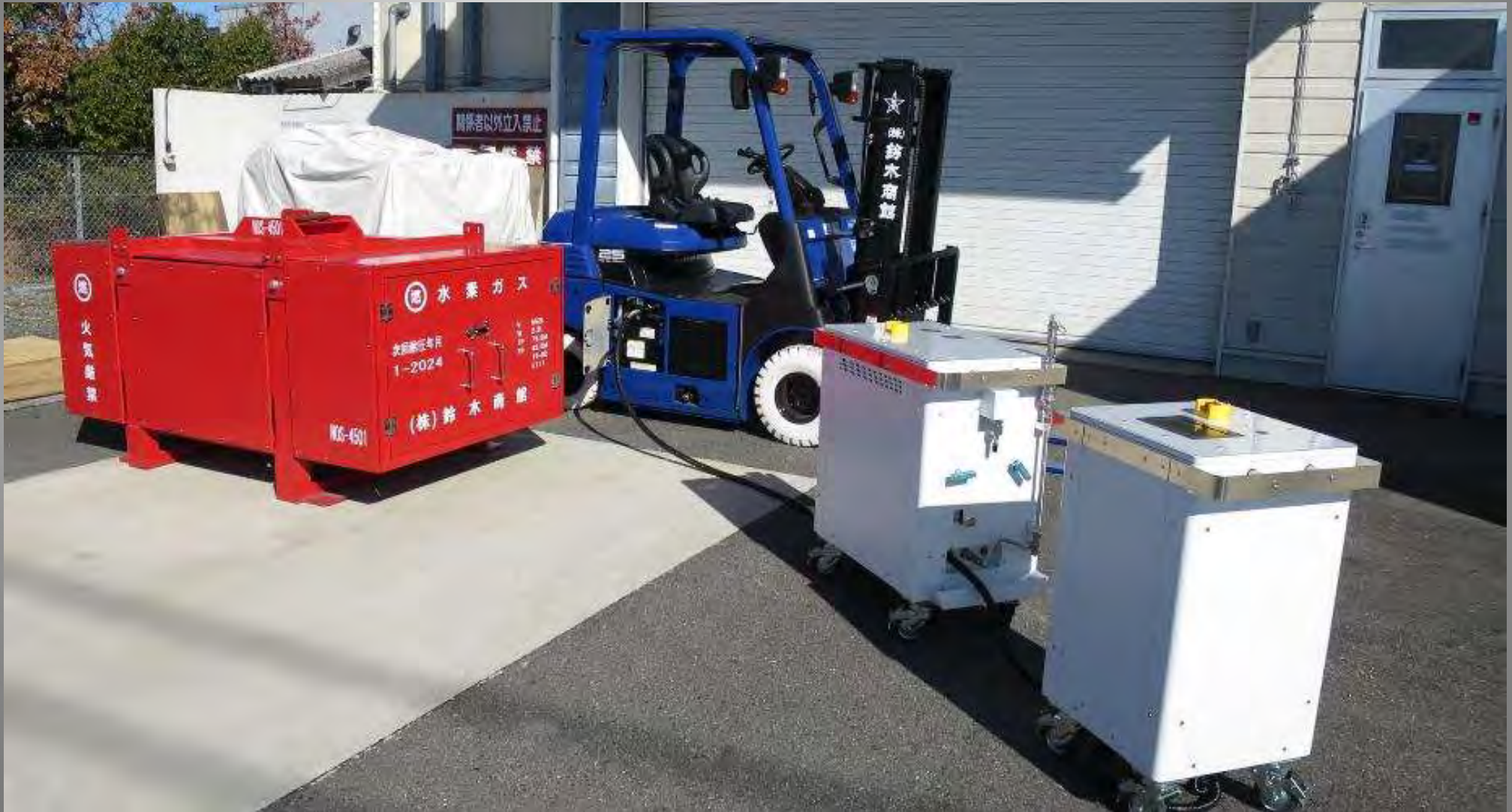
Bell Station Mini35と45MPaカードル
