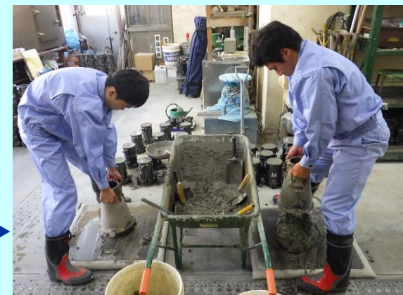
生コンクリートのスランプ試験の体験
