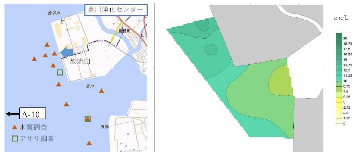
図5 豊川浄化センター周辺の測点配置(左)と2021年9月から2022年3月までの平均クロロフィル濃度(右)
