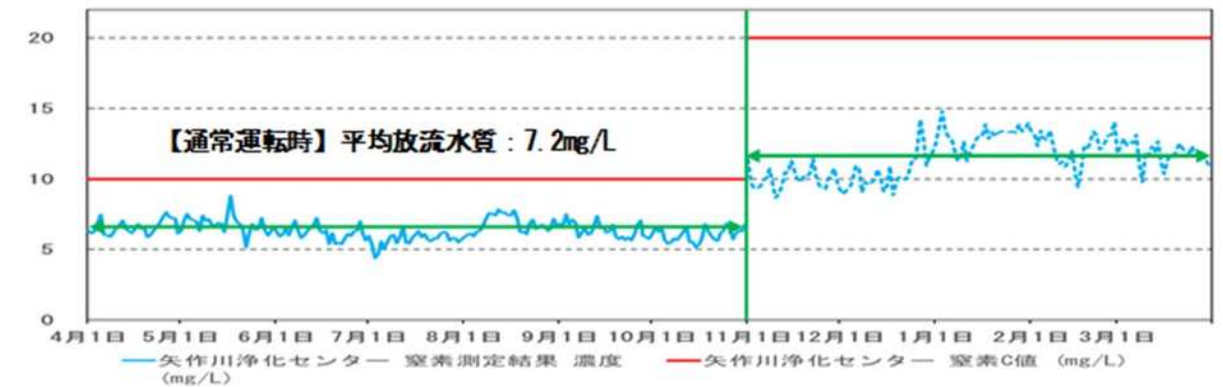
図1 栄養塩管理試験運転による放流水の窒素濃度増加イメージ
