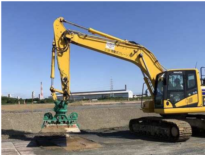
敷鉄板敷設用マグネットアタッチメント付きバックホウ
