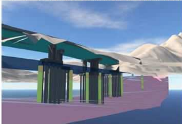
支持層への根入れを3次元的に確認
