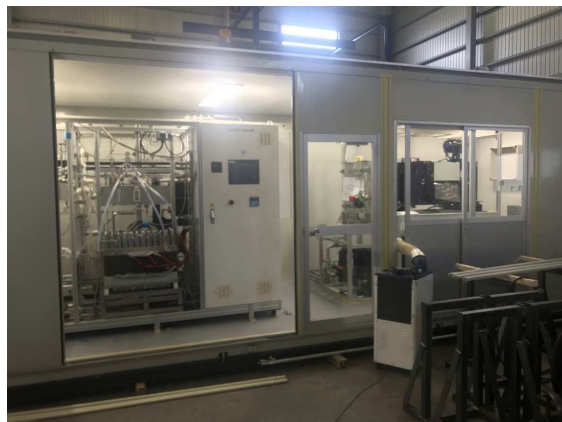
A : 水素酸素発生装置、燃料電池発電装置×2
