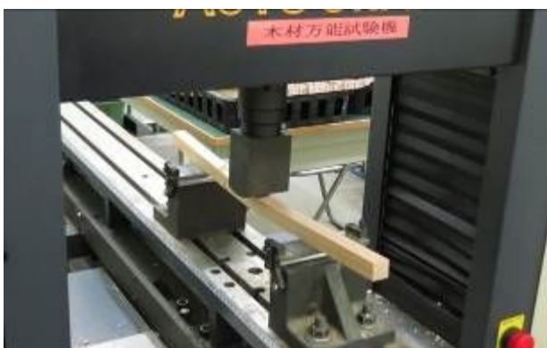
写真－2 材質調査（曲げ強さ等の測定）
