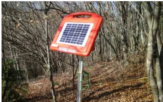
電気さく電源装置（ソーラーバッテリー方式）
