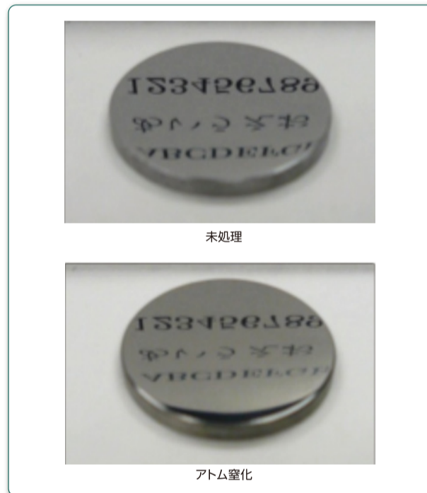
図2 金型用鋼のアトム窒化
