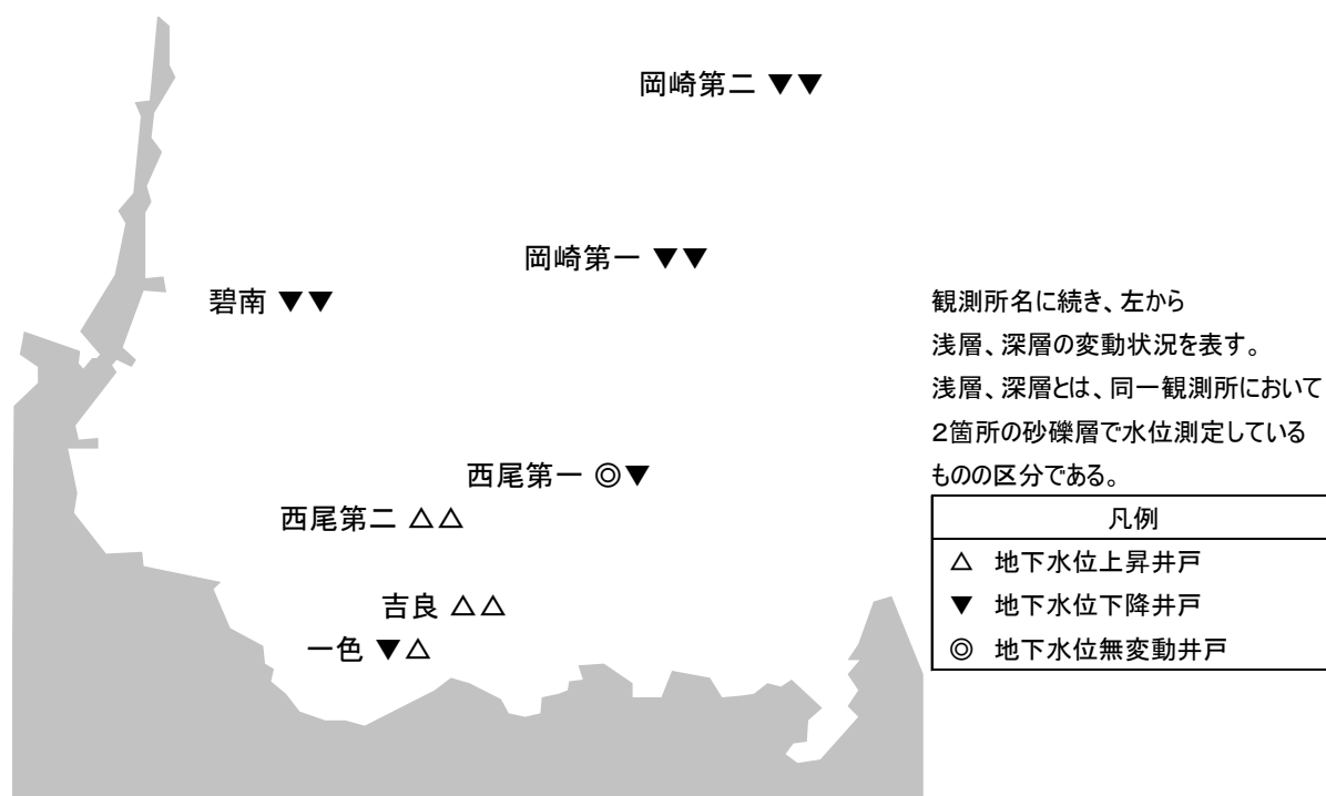
図2-7 西三河観測井の地下水位変動状況 （2021年と2022年の平均地下水位比較）
