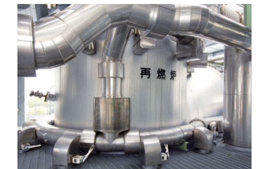
⑤再燃炉(縦型円筒炉) 炭化炉から排出される熱分解ガスおよび乾燥排ガスをガス温度850℃以上滞留時間2秒以上の高温で完全燃焼させ、N 2 O排出量を低減させます。
