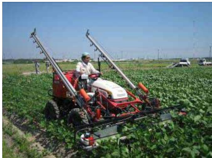
省力摘心機による作業状況
