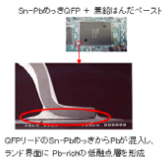
【写真2】QFPリードに生じたクラック
