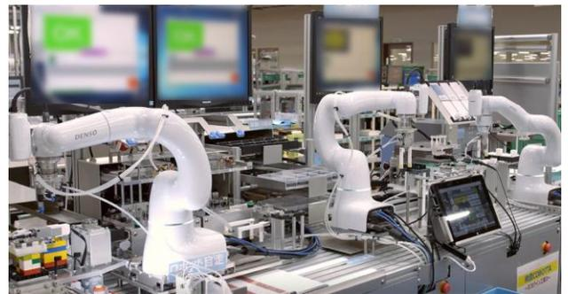
人協働ロボットCOBOTTAによる自動組み立てライン
