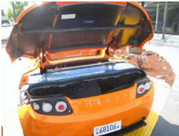
テスラ・ロードスター車両後部の電池搭載の様子)
