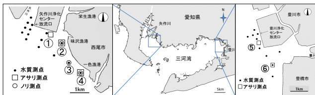
図26 矢作川浄化センター及び豊川浄化センターの放流口周辺に設けた水質調査測点
