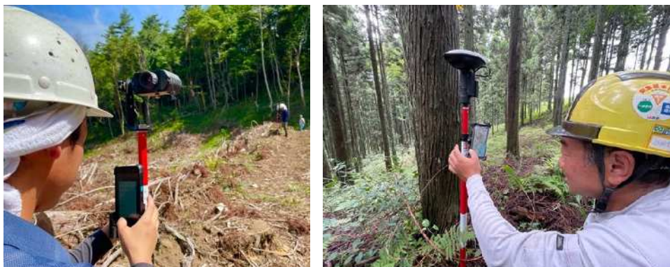
左:GNSSを使わない従来の2名による測量、右:GNSSを使った1名による測量 出所:令和5年度「新しい林業」に向けた林業経営育成対策のうち 経営モデル実証事業(株式会社サンライフ)
