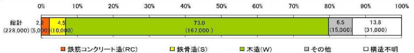
図一 被災した建物の構造の状況
