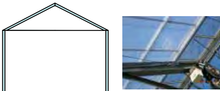
図4-2 着色部分を二層化した空気膜施設（屋根内側にフィルムを固定）
