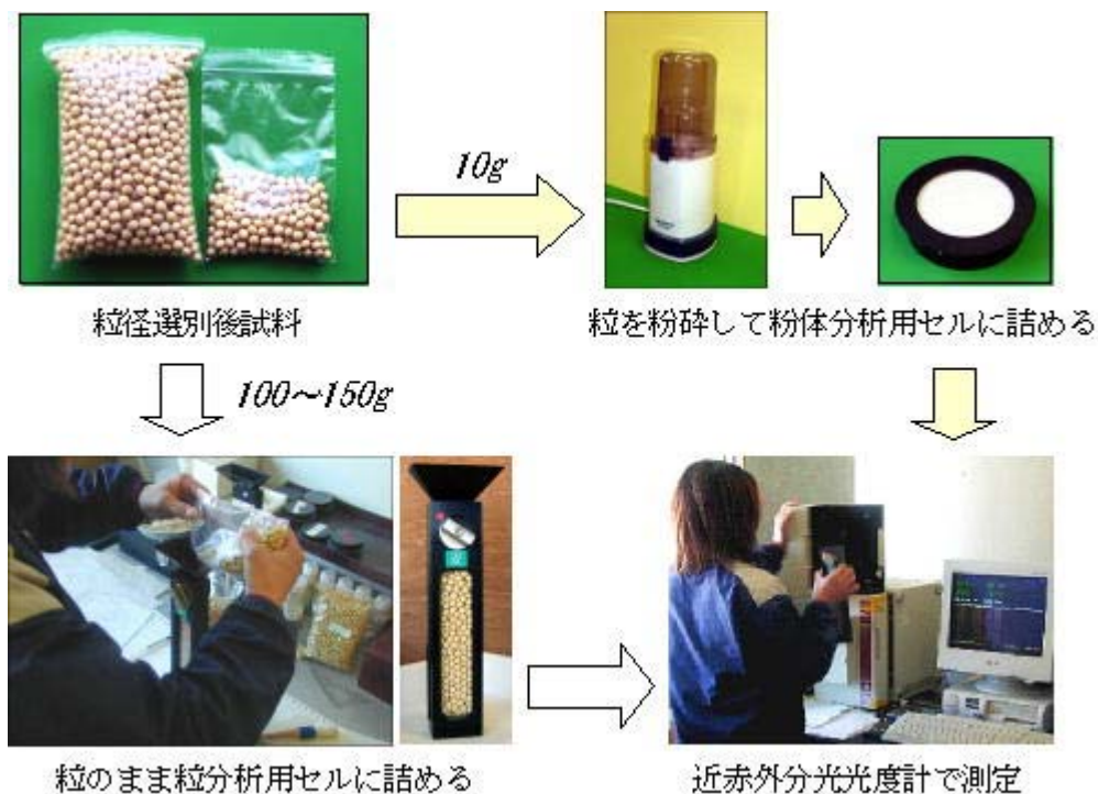
図 -2-2-2 近赤外分光光度計によるダイズの成分分析手法
