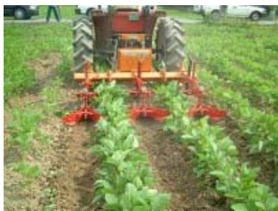
図 -3-4-2 市販機による 心土破碎+培土作業
