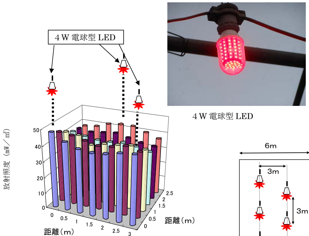
図9 間口6mの高設栽培ハウスに2列、ベッド上面から1.5mの高さに3m間隔でLEDを配置した場合のベッド上面の放射照度
