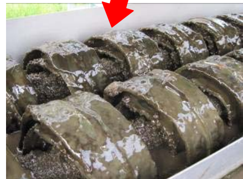
接触材に付着・増殖する活性汚泥 (この汚泥が排水を浄化します)
