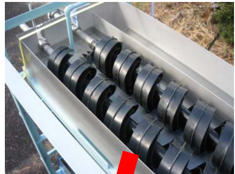
独自に考案した スクリー型接触材
