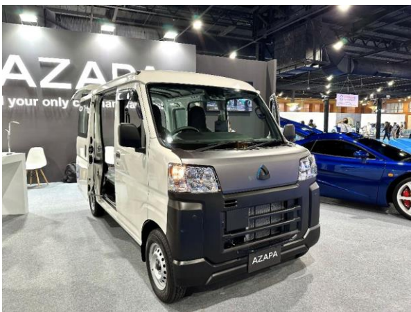
図 13 日本の自動車メーカーが販売しているガソリン車をEVにコンバージョンした車両 (筆者撮影)
