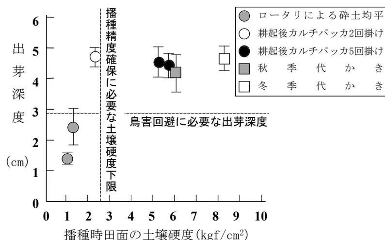
図14 整地の方法が播種時の土壌硬度に及ぼす影響
