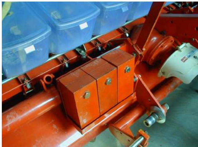
図 29 不耕起V溝直播機のウエイト
