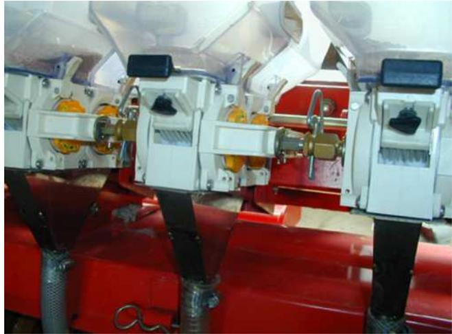
図 27 条止めのためのピン
