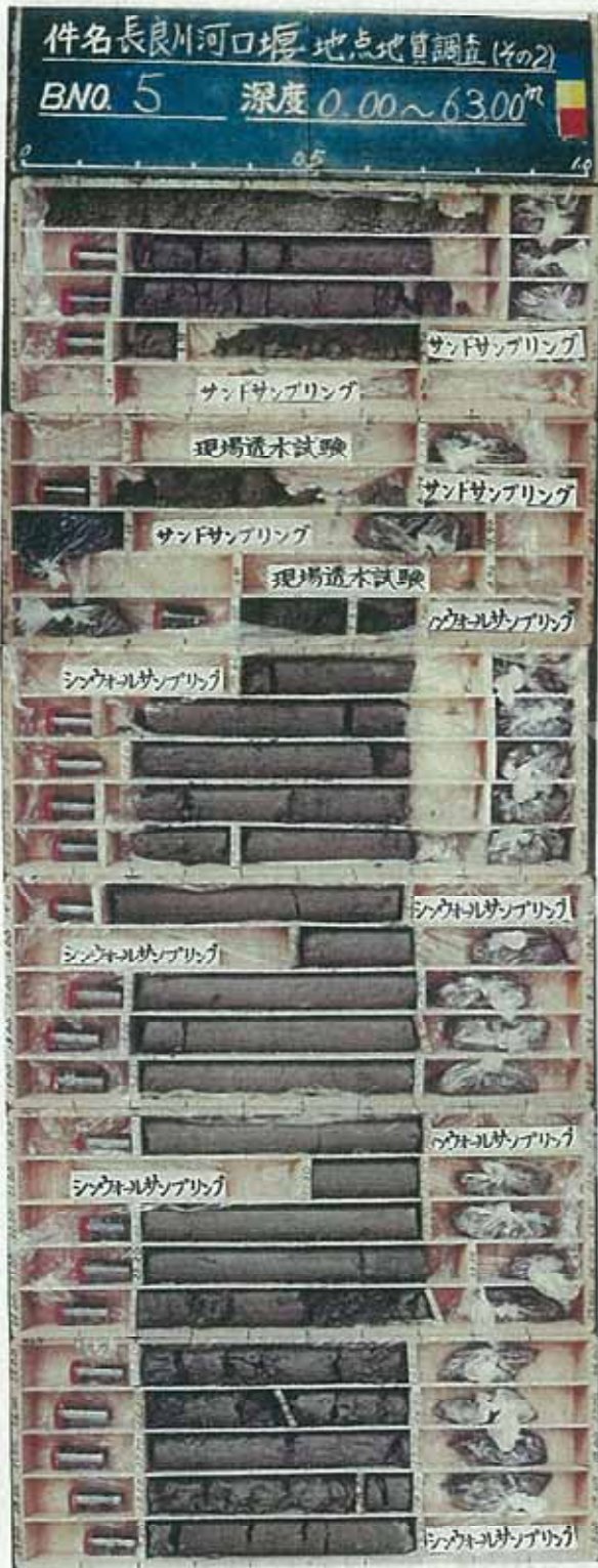
図 5.5.7(1) 堰運用前(昭和63年)の底質堆積状況(No.5)
