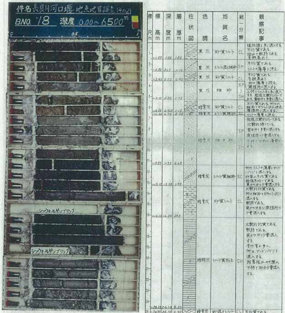
図 5.5.9(1) 堰運用前(昭和63年)の底質堆積状況(No.18)
