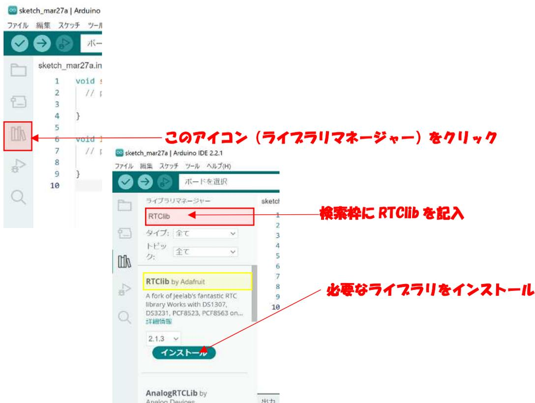
図のように、Arduino IDE の左端のアイコンの中から上から3つ目のライブラリマネージャーのアイコンをクリックし、検索窓に「RTClib」と入力すると候補がでます。
