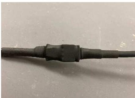
ドライヤー等で熱して収縮させる\*
