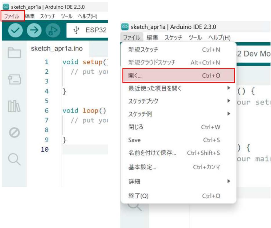
PCでArduino IDEを開いたら、左上の「ファイル」をクリックして、開くを選択します。続いて、ダウンロードしたサンプルプログラムを確認して選択します。（特にダウンロード先を指定していない場合、WindowsPCではCドライブのユーザー名フォルダに含まれているダウンロードフォルダに保存されます。）
