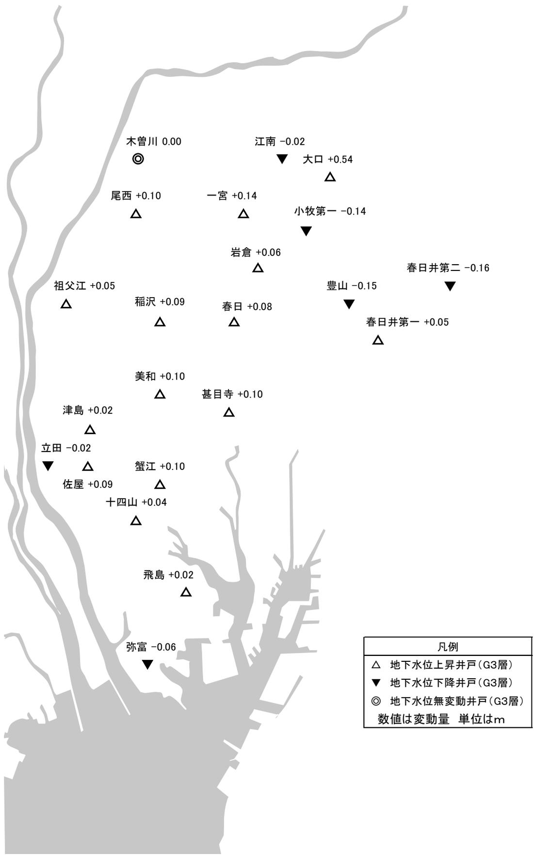
図 2 - 5 観測井 G 3 層の地下水位変動状況 (22 井)
