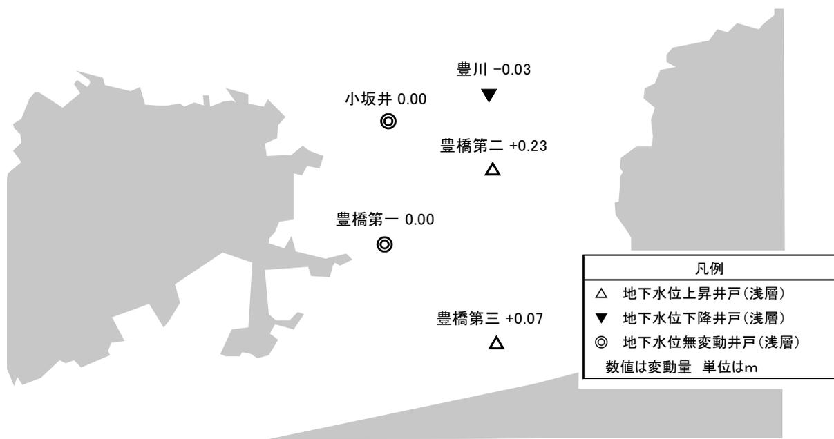
図 2 - 12 東三河浅層の地下水水位変動状況 (5井)
