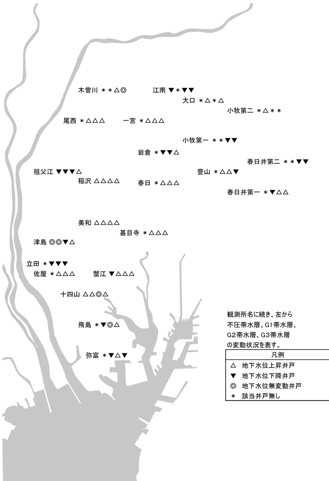
注) G1、G2、G3帯水層とは、濃尾平野の砂礫層を指し、地表より順に第一、第二、第三砂礫層と呼ばれ、利用可能な地下水が多く含まれる地層（被圧帯水層）である。不圧帯水層とは、地表面近くの砂層を指し、自由水面を持った地下水が流れる地層である。
