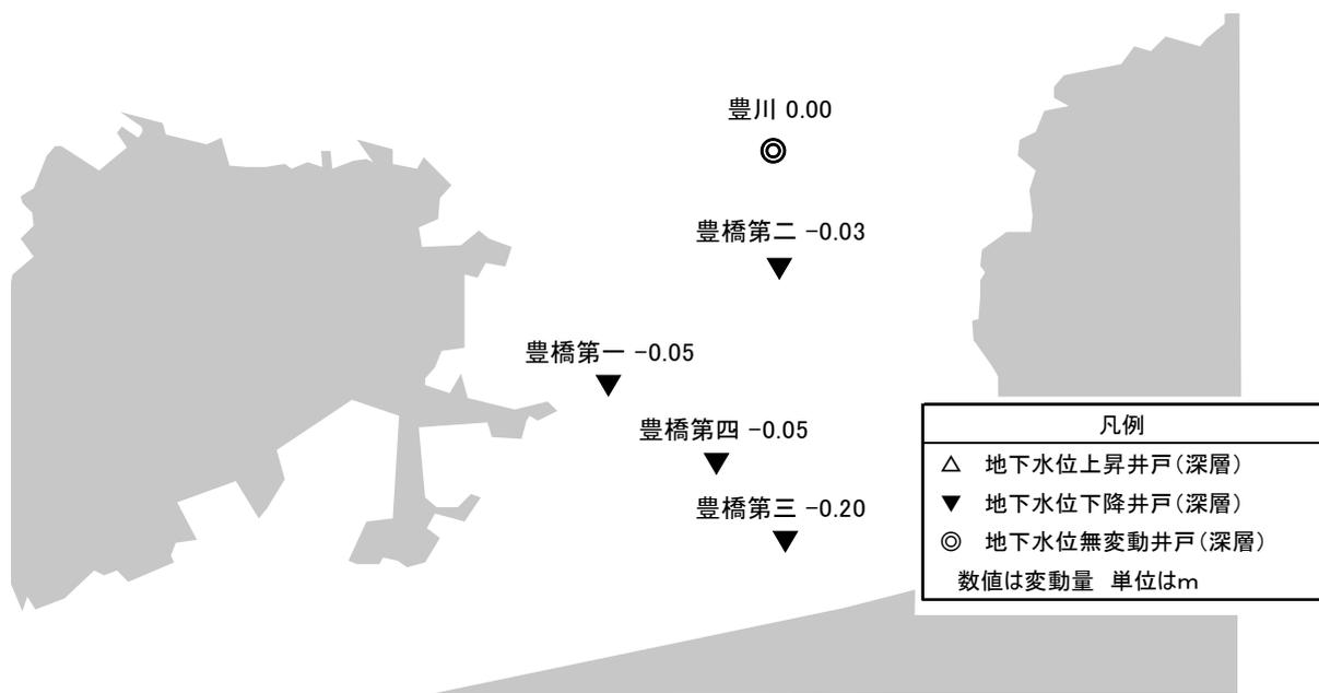
図 2 - 13 東三河深層の地下水水位変動状況 (5井)
