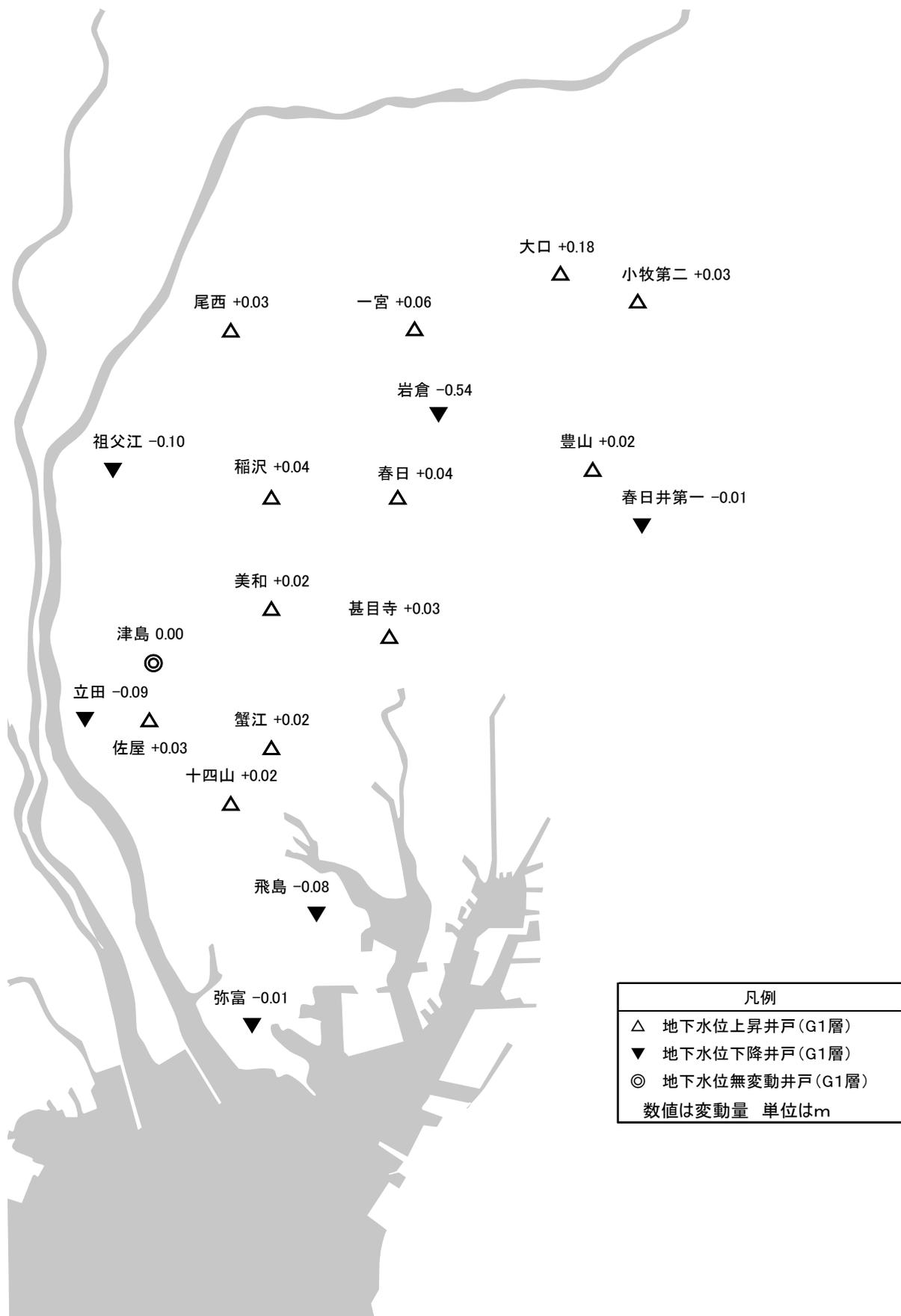
図 2 - 3 観測井 G 1 層の地下水位変動状況 (19 井)
