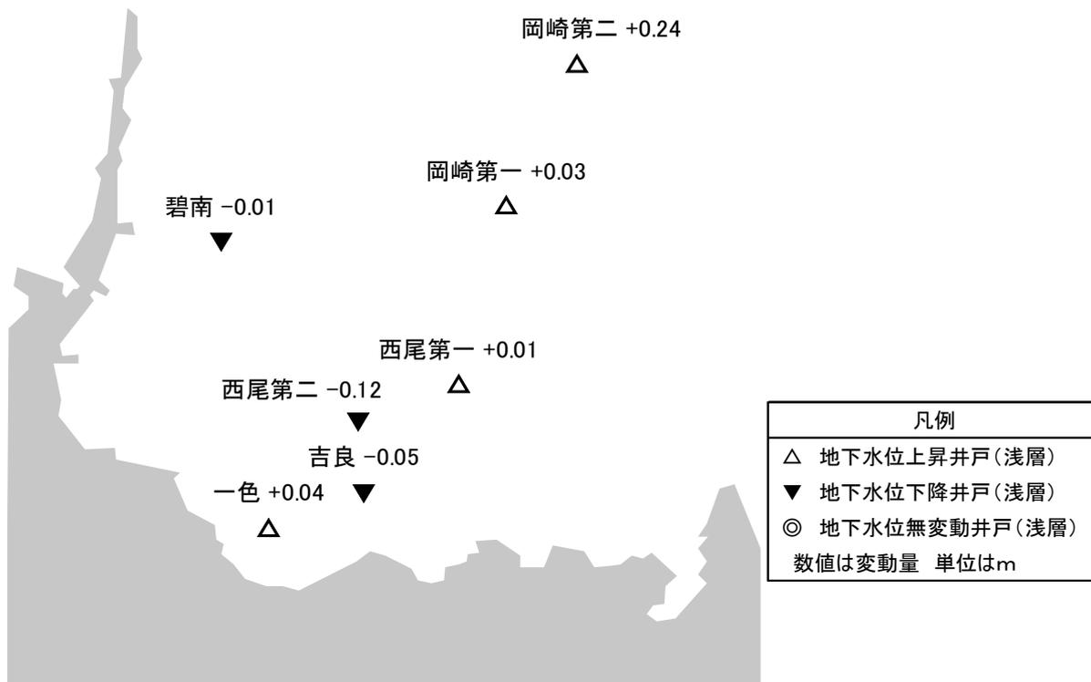
図 2 - 8 西三河浅層の地下水位変動状況 (7 井)
