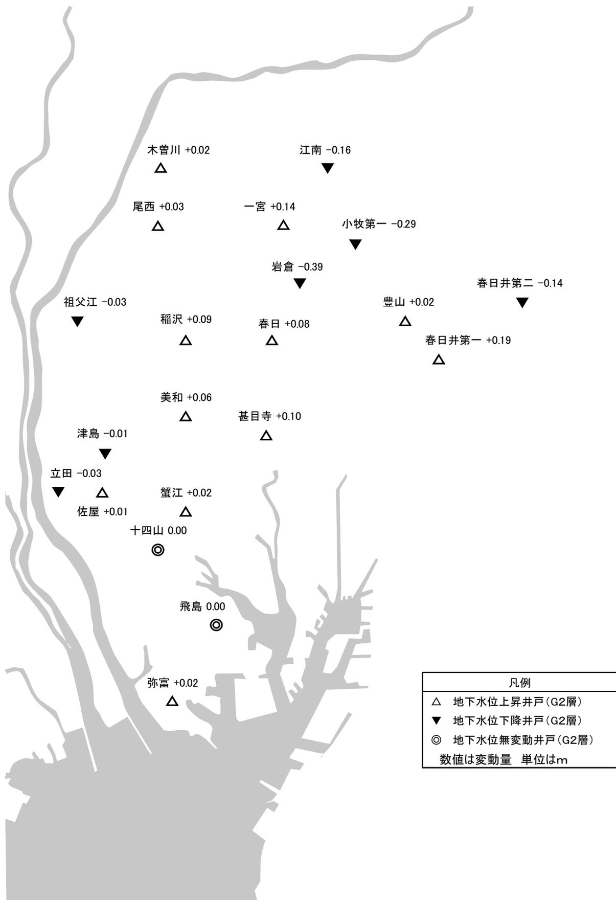
図 2 - 4 観測井 G 2 層の地下水位変動状況 (21 井)
