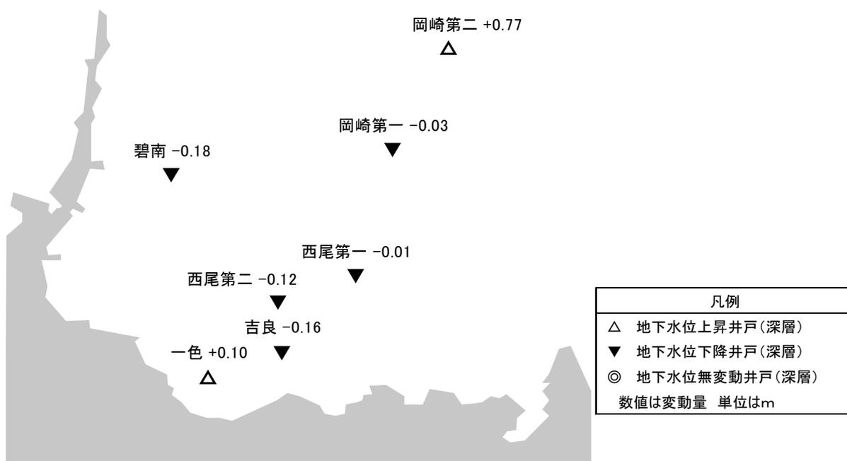
図 2 - 9 西三河深層の地下水位変動状況 (7 井)
