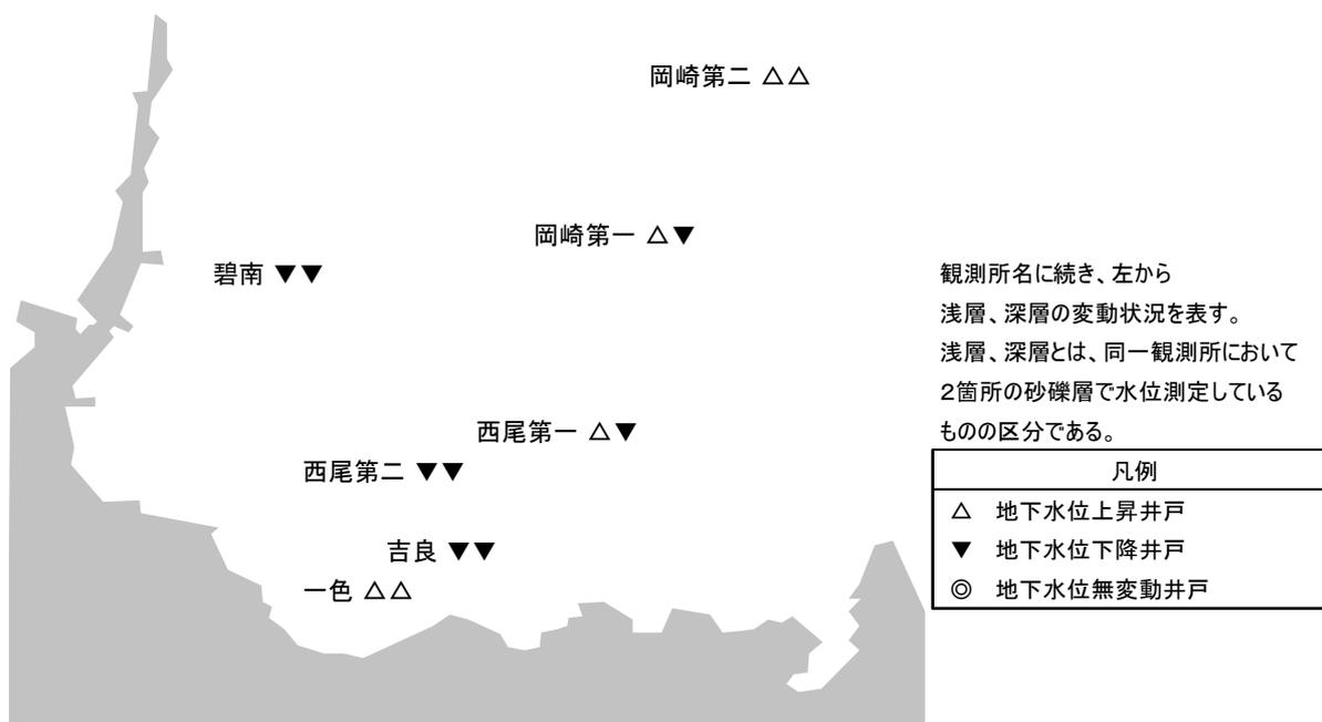
図2-7 西三河観測井の地下水位変動状況
