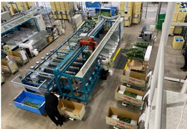
バラ受け機械装置 (JA 愛知みなみ)
