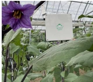
環境の多点計測に用いた測定機器
