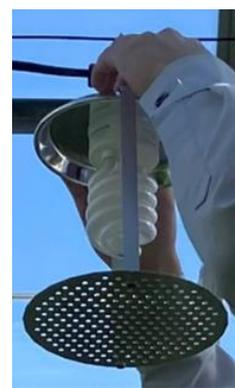
写真4 蛍光灯に近接照射用補助具を設置した事例
