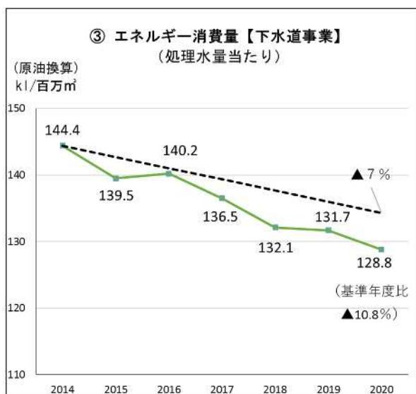
下水汚泥から発生する消化ガスの利用による重油使用量の削減や省エネ型設備への更新(水処理設備の更新)等により減少した。さらに、水量や水質の変動に対応した効率的な運転により、処理水量当たりのエネルギー消費量が減少した。
