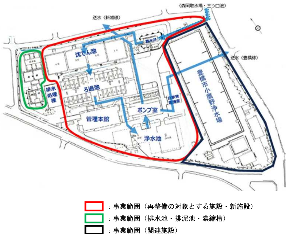
図表4 豊橋浄水場平面図
