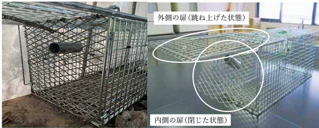
写真1 二重扉の構造にした捕獲器
