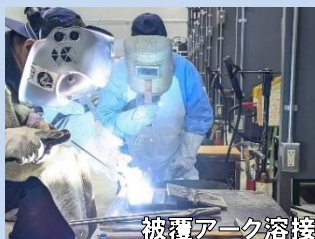
被覆アーク溶接
