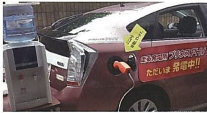
イベントでの外部給電機能の活用
