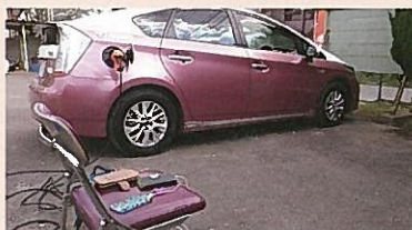
豪雨被害を受けた常総市での外部給電活動
