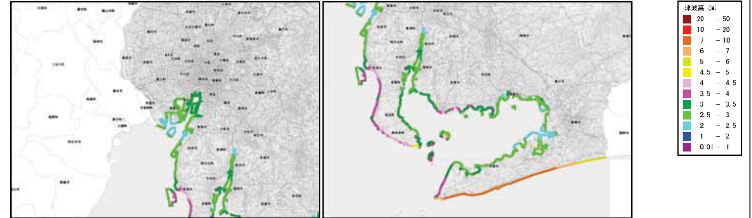
過去地震最大モデルの津波の津波高(満潮水位 地盤変動量考慮)
