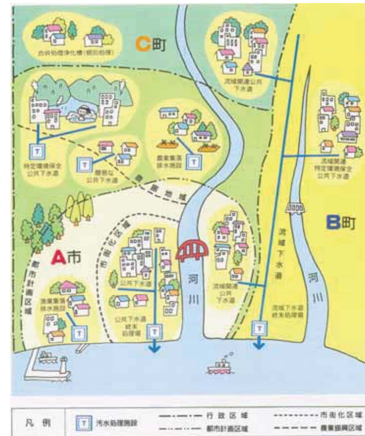
生活排水処理の概念図 資料：生活排水処理施設整備計画 (三重県)
