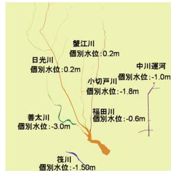
図2-9 個別水位を与えた河川の初期水位 (例. 日光川水系周辺_0010-01領域)
