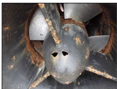
損傷したポンプ
