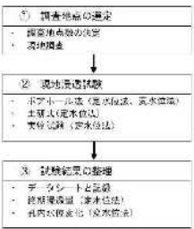
図 2-9-1 現地浸透試験の流れ
