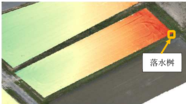
図1 排水対策施工前のほ場傾斜を表した画像 色の濃淡が地表面の高低を表す。 緑(高い)～赤(低い)
