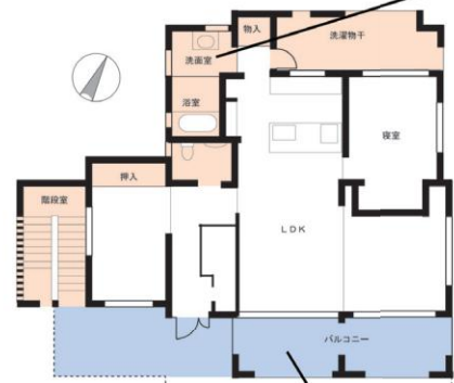
南側に軒下の影の空間を設けて涼風をよびこむ
