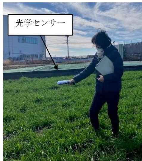
光学センサーを用いて 茎立期のNDVIを計測する様子
