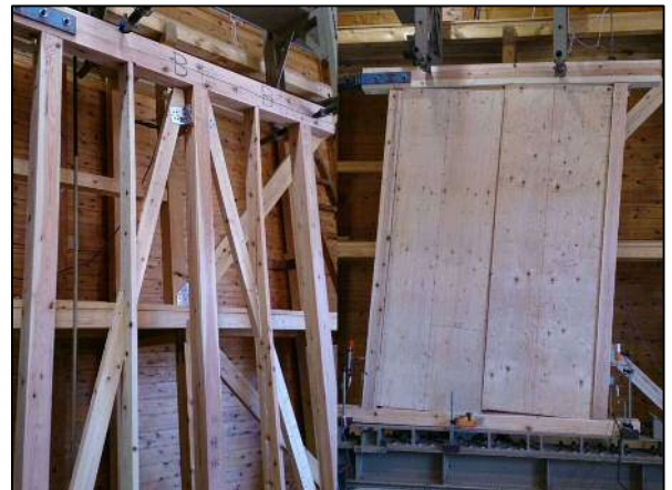
耐力壁の面内せん断の試験
