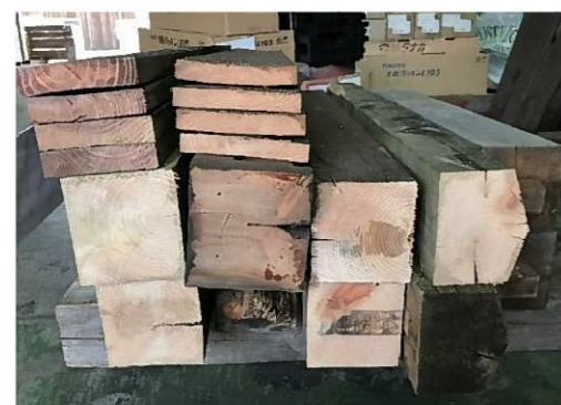
解体材の観察 解体材の断面内部損傷はなかった 防虫防腐剤の注入効果が出ている。
